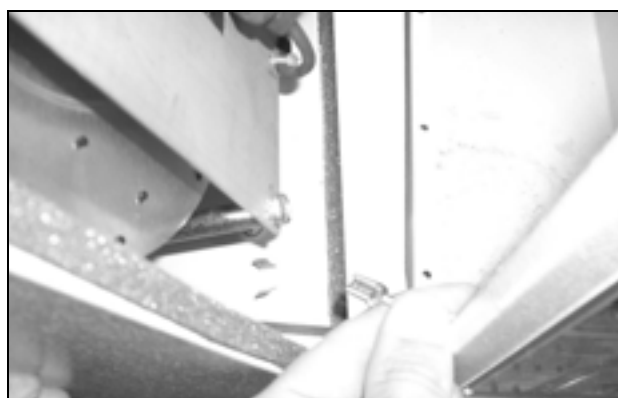
Abb. 55: Erdungskabel zwischen Haube und Chassis lösen (2)
