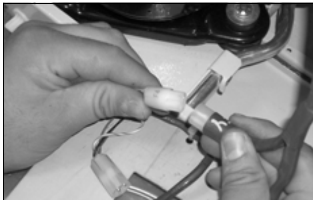
Abb. 48: Steckverbindungen des Lüfters abziehen
