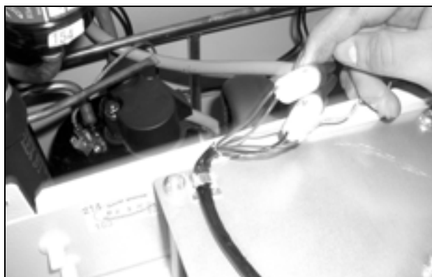
Abb. 71: Steckverbindungen des Lüfters abziehen (2)
