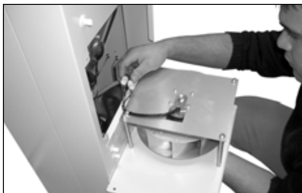
Abb. 70: Steckverbindungen des Lüfters abziehen (1)
