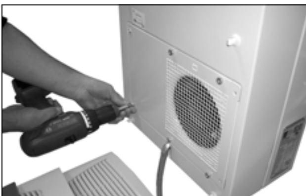
Abb. 46: Außenkreislaufflüter ausbauen (vier Schrauben lösen)
