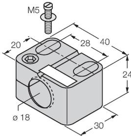
Befestigungsschelle für Gewinderohrsensoren, mit Festanschlag; Werkstoff: PA6
