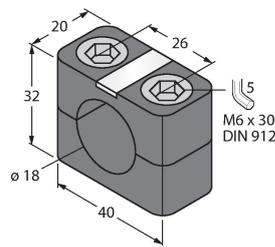
Befestigungsschelle für Gewinderohrsensoren; Werkstoff: PA66-GF
