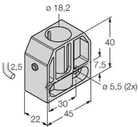
Befestigungsschelle für Gewinderohrsensoren; Werkstoff: PA66-GF
