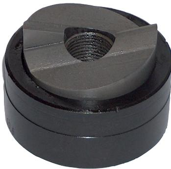
Dieser Blechlocher für VA-Material spaltet das Abfallstück in 2 Teile. Auf diese Weise wird das Festklemmen des Abfallstücks an der Zugschraube und in der Matrize verhindert.
