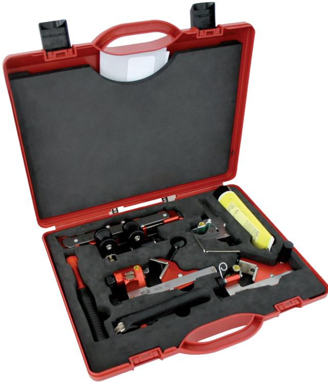
Geeignet zum Absetzen des Außenmantels, speziell auch mit Al-Schicht, zum Schälen der Feldbegrenzungsschicht, zum Entfernen und Anfasen der Primärisolation an MS-Kabel
