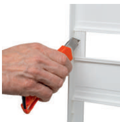
Die Geräteeinheiten können durch Ausbrechen der Vorprägungen von 12 auf 14 TE verbreitert werden.
