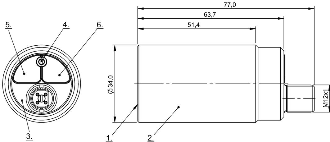
1) aktive Fläche 2) Gehäuse 3) Deckel 4) Poti 5) LED Betriebsspannung 6) LED Funktionsanzeige
