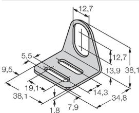
BSS-12 6901321 Befestigungsschelle für Glatt- und Gewinderohrsensoren; Werkstoff: Polypropylen
