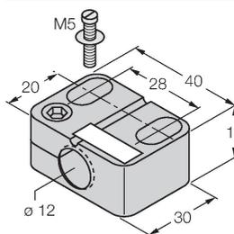
MW-12 6945003 Befestigungswinkel für Gewinderohrsensoren; Werkstoff: Edelstahl A2 1.4301 (AISI 304)
