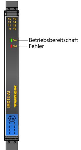
Über den 1-kanligigen HART®-Messumformer-Speisetrenner IMX12-AI01-1I-1IU-H0/24VDC/CC werden eigensichere HART®-2-Draht-Messumformer im Ex-Bereich betrieben und die Messsignale in den Nicht-Ex-Bereich übertragen. Neben den Analogsignalen können bidirektional auch die digitalen Signale der HART®-Kommunikation übertragen werden. Weiterhin können aktive und passive 2-Draht-HART®-Transmitter betrieben werden.
