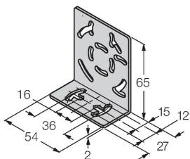
Montagewinkel, Edelstahl, für Bauformen QS18, QS30, MINI-BEAM, QM42/QMT42
