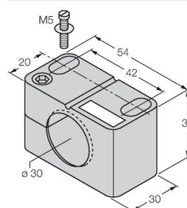
Befestigungsschelle für Gewinderohrsensoren, mit Festanschlag; Werkstoff: PA6
