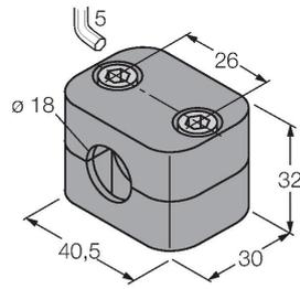
Befestigungsschelle für Glatt- und Gewinderohrsensoren; Werkstoff: Polypropylen
