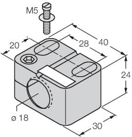
Befestigungsschelle für Gewinderohrsensoren, mit Festanschlag; Werkstoff: PA6
