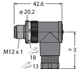
Konfektionierbarer Stecker, M12 x 1, gewinkelt, 5-polig, Schraubklemmanschluss, Leitungsdurchlass 4.0 bis 6.0 mm, Adernquerschnitt/Klemmvermögen 0.14 bis 0.75 mm<sup>2</sup>, Kunststoffgehäuse, Metallüberwurfschraube
