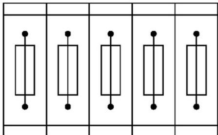
Sicherungsklemmen in Verbundanordnung, Block bestehend aus 5 Sicherungsklemmen
