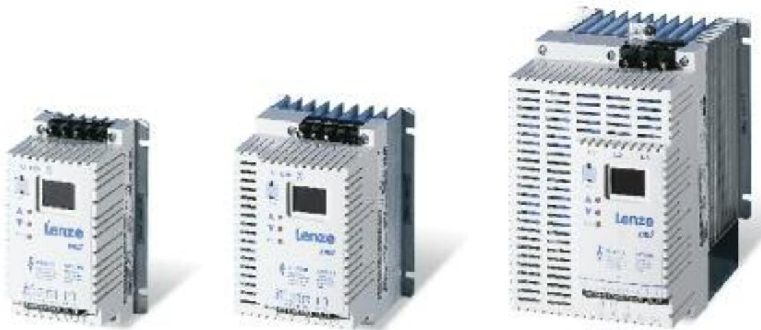
Die Programmierung erfolgt direkt am Umrichter oder über ein batteriebetriebenes EPM-Programmiergerät. Konfigurationen sind damit komfortabel offline zu erstellen oder zu bearbeiten. Das Gerät speichert bis zu 30 verschiedene Antriebsprogramme als Datei. Das Kopieren von EPM zu EPM, Datei auf EPM oder das Rückschreiben des EPM in eine Datei ist auf Knopfdruck in zwei Sekunden erledigt.
