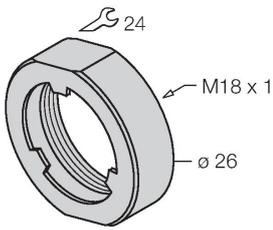
Stoßschutzmutter für M18x1 Gewinderohrgeräte; Werkstoff: Edelstahl A2 1.4305 (AISI 303)
