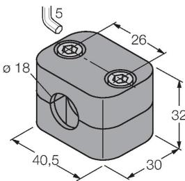
Befestigungsschelle für Glatt- und Gewinderohrsensoren; Werkstoff: Polypropylen
