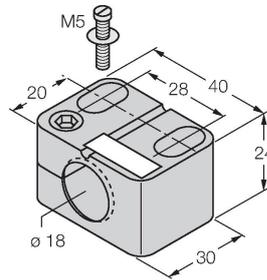
Befestigungsschelle für Gewinderohrsensoren, mit Festanschlag; Werkstoff: PA6
