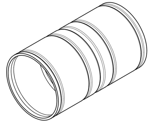
zur geraden Stoßstellenverbindung von zwei Steckrohren-IEC
