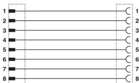
Kontaktbelegung des M12-Stecker und der M12-Buchse
