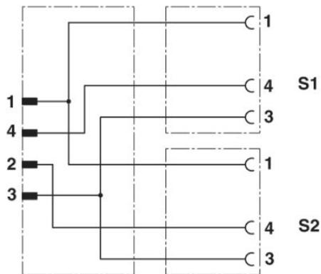
Kontaktbelegung des M12-Steckers und der M8-Buchsen
