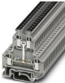
Doppelstockklemme, Querschnitt: 0,2 mm<sup>2</sup> - 4 mm<sup>2</sup>, AWG: 24 - 12, Anschlussart: Schraubanschluss, Breite: 6,2 mm, Farbe: grau, Montageart: NS 35/7,5, NS 35/15, NS 32
