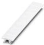
Marker für Klemmen, Streifen, weiß, beschriftet, beschriftbar mit: Plotter, längs: L1, L2, L3, N, PE, L1, L2, L3, N, PE, Montageart: Verrasten in hoher Schildchennut, für Klemmenbreite: 6,2 mm, Schriftfeldgröße: 6,15 x 10,5 mm
