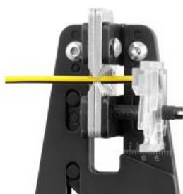
Kabel an Längenanschlag anlegen
