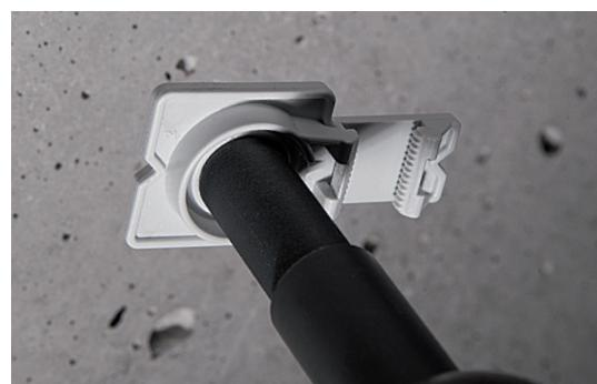
Die beiden Ringe sind an die Schussapparate von Hilti (GX 120-ME), Spit (PULSA 700 E) und Würth angepasst. An der Mündung der Schusspistolen dieser Hersteller klemmt die ESP, somit muss diese nicht mit der zweiten Hand gehalten werden.
