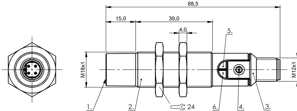
1) aktive Fläche, 2) Gehäuse, 3) Deckel, 4) Poti, 5) LED Betriebsspannung, 6) LED Funktionsanzeige
