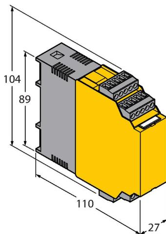
Grenzwertsignalgeber; einkanalig; Eingang 0/4...20mA oder 0/2...10V; Versorgung eines Zweidraht- oder Dreidraht- Transmitters/Sensors; Grenzwerteinstellung über Teach-Taster; Drei Relaisausgänge mit je einem Schließer; abziehbare Klemmenblöcke; 27 mm Breite; Universelle Betriebsspannung 20... 250VUC; weitere Grenzwertsignalgeber im Katalog Interfacetechnik
