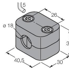
Befestigungsschelle für Glatt- und Gewinderohrsensoren; Werkstoff: Polypropylen
