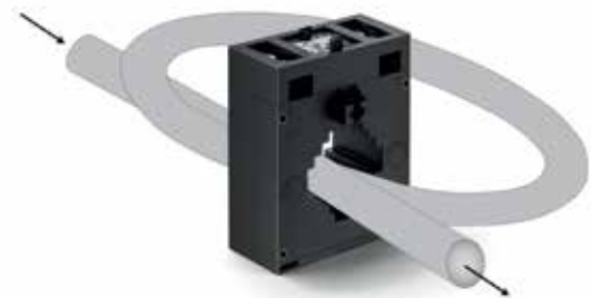
Äquivalent zu einem Wandler 100 / 5 A, I_{max} = 50 \text{ A}
