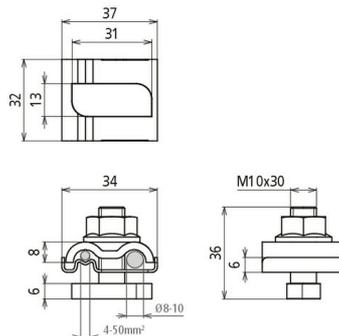
UNI-Erdungsklemme zum Einbinden von Anlagenteilen in den Funktionspotentialausgleich, Blitzschutz-Potentialausgleich oder in die Funktionserdung. Ausführung NIRO, mit Hammerkopfschraube M10 (31/13) und Sperrzahnmutter.
