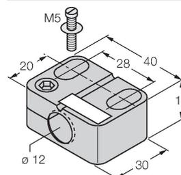
Befestigungsschelle für Gewinderohrsensoren, mit Festanschlag; Werkstoff: PA6
