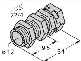
Schnellmontagehalterung mit Festanschlag; Werkstoff: Messing verchromt. Außengewinde M16 x 1. Hinweis: Der Schaltabstand der Näherungsschalter kann sich durch Verwendung von Schnellmontagehaltern ändern
