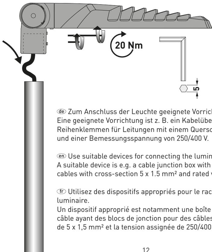
de Zum Anschluss der Leuchte geeignete Vorrichtungen verwenden. Eine geeignete Vorrichtung ist z. B. ein Kabelübergabekasten mit Reihenklammern für Leitungen mit einem Querschnitt von 5 x 1,5 mm<sup>2</sup> und einer Bemessungsspannung von 250/400 V.
