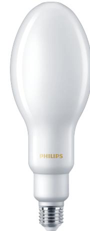
Die TrueForce Core LED Familie bietet den idealen Ersatz für eine Vielzahl von Entladungslampen. Jede Lampe kann direkt an 230V betrieben werden. Der Kolben jeder TrueForce Core besteht vollständig aus Glas, wie bei einer herkömmlichen Entladungslampe. Durch ihren Ausstrahlwinkel von 300° und der Schutzklasse IP65 (wasserdicht) sind sie geeignet für die Innen- und Außenbeleuchtung.
