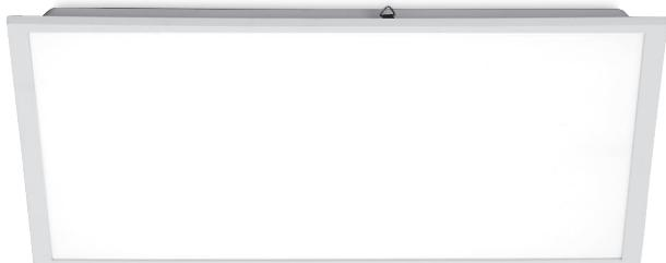
Innovatives BackLit LED Panel Design konzipiert für kommerzielle Anwendungen ohne Lichtleiterplatte. PMMA Linsentechnologie ermöglicht in Verbindung mit Mikoprismatischer Streuscheibe eine homogene Lichtverteilung bei exzellenter Entblendung. Einfache Installation durch vorinstallierten flicker-freien LED Treiber. Geeignet für Installationen in Rasterdecken oder Aufbaugehäusen.
