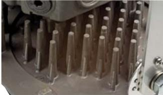
Mit großen Kühlrippen und einem innovativen Wärmeableitungssystem bietet Eaton ein Gehäusedesign, mit dem die LED-Chip Temperatur immer unterhalb der kritischen Werte liegt. Damit wird auch bei +55 °C Umgebungstemperatur die Lebensdauer der LED (L80) von min. 60.000 h gewährleistet.
