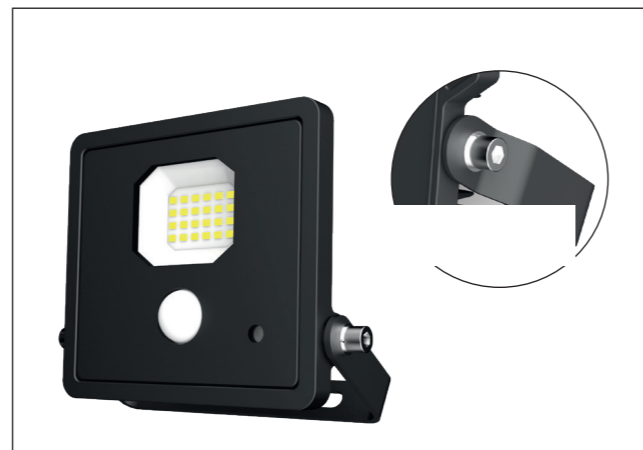
Abb. 5: Entfernen Sie den Silikonstopfen und lösen Sie die Schraube mit einem Inbusschlüssel. Stellen Sie den gewünschten Montagewinkel ein und setzen Sie danach den Silikonstopfen wieder ein.
