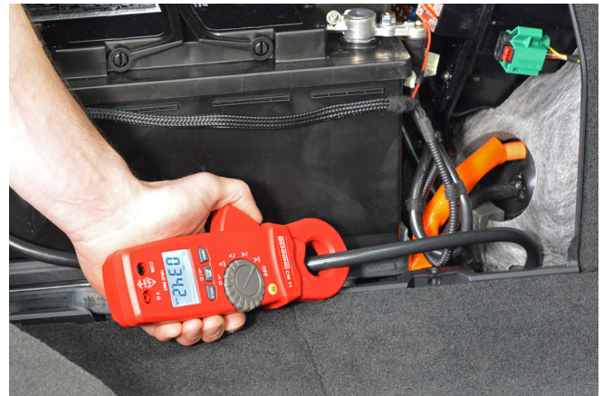
Ruhestrommessung an der Batterie zuleitung
