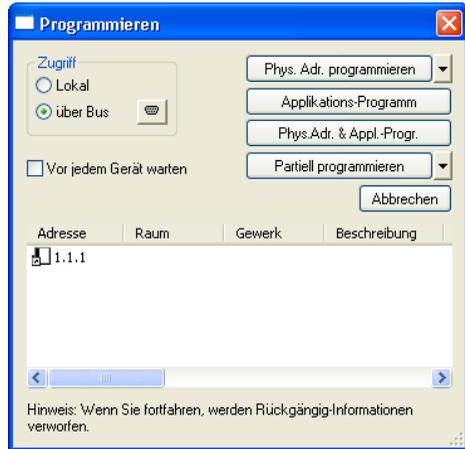
3. Der Programmiervorgang wird gestartet und Sie werden aufgefordert, den Programmierknopf des Gateways zu drücken. Nach ca. 4 Sekunden verlischt die rote LED, die physikalische Adresse ist jetzt programmiert.
