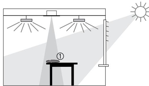
$$\text{Raum-Korrekturfaktor} = \frac{\text{Helligkeitswert an der Decke}}{\text{Helligkeitswert auf der Arbeitsfläche}}$$
