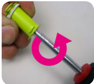
Abb.5: Glasfaserkabel auf Spule wickeln
