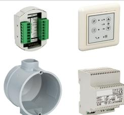
Steuerungs-Set bestehend aus Steuereinheit, Netzteil und Bedienteil zur Steuerung von bis zu 4 Lüftungsgeräten. Die Steuereinheit ist mit einer LED ausgestattet, die den Zeitpunkt zur Reinigung bzw. zum Austausch des Filters signalisiert. Die Anzeige erfolgt abhängig von der Betriebsdauer. Der Einbau des Bedienteils erfolgt in die mitgelieferte Unterputzdose. Das Netzteil ist für eine Hutschienenmontage ausgelegt.
