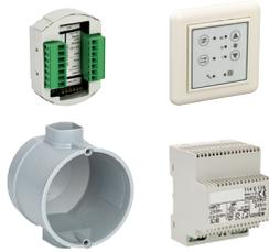
Steuerungs-Set bestehend aus Steuereinheit, Netzteil und Bedienteil zur Steuerung von bis zu 8 Lüftungsgeräten. Die Steuereinheit ist mit einer LED ausgestattet, die den Zeitpunkt zur Reinigung bzw. zum Austausch des Filters signalisiert. Die Anzeige erfolgt abhängig von der Betriebsdauer. Der Einbau des Bedienteils erfolgt in die mitgelieferte Unterputzdose. Das Netzteil ist für eine Hutschienenmontage ausgelegt.
