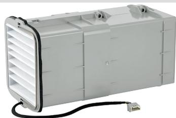
Lüftereinschub mit einem Gehäuse aus Kunststoff, energieeffizientem EC-Motor, Aluminiumwärmeübertrager bestehend aus vier Segmenten, Außenfilter G2 und Innenfilter G4. Drehrichtungsumkehr des Volumenstroms nach 40 Sekunden.
