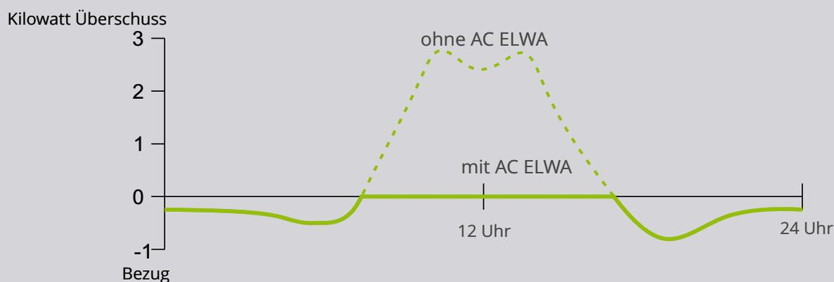
An das PLA können bis zu 6 AC ELWAs angeschlossen werden. Das erlaubt Überschuss-Management bis zu 18 kW!
