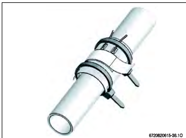
Bild 27 Montage des Taupunktfühlers (Beispiel)
