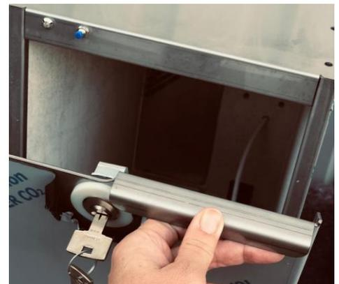
3. **Standard Schnapper** – Durch das ziehen an der Öse nach unten öffnet sich der Schnapper und die Klappe kann geöffnet werden. Beim schließen der Klappe hilft ein leichtes drücken gegen die diese damit der Schnapper in die obere Verriegelung greift.
