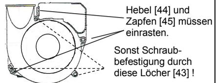
8. Ventilatoreinsatz/Abluftelement gleichmäßig parallel auf die beiden Zapfen [45] schieben. Darauf achten, dass die beiden Rastnasen der Zapfen sowie der Rasthebel [44] hörbar einrasten.
