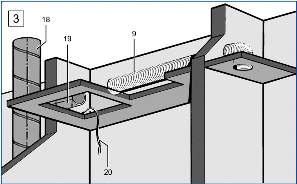
5. Zum ER-UP-Gehäuse passende Anschlussleitung [18] an der Hauptleitung anschließen und lüftungstechnisch abdichten.
