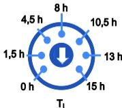
**Poti Ti:** Betriebsdauer. Bei Linksanschlag Intervallsteuerung aus.
