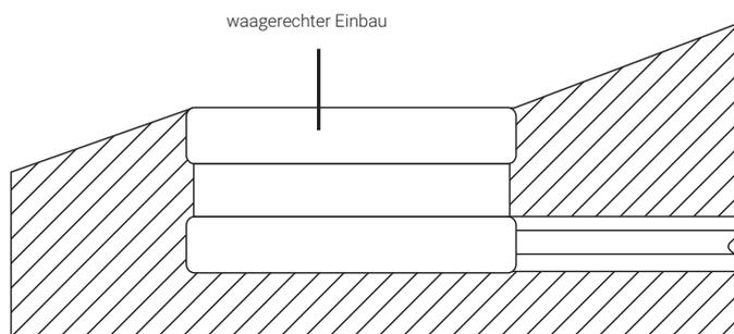
Sensoreinbau in schräger Fläche
