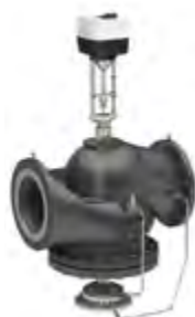
NovoCon® M/L/XL Digitaler Getriebemotor zur Anbindung von AB-QM 40-100/125-250 in die Gebäudeautomation über BACnet/Modbus/0-10V.
