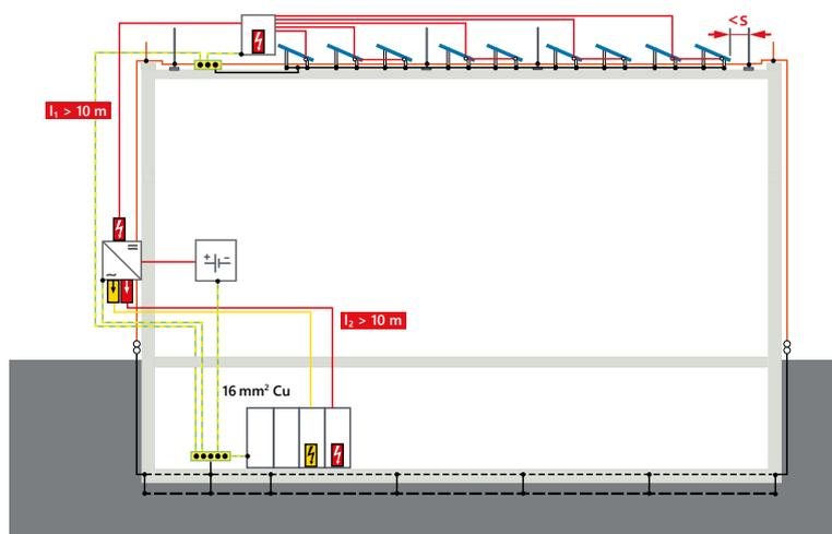
Kann der nach DIN EN 62305-3 errechnete Trennungsabstand (s) nicht eingehalten werden, muss ein Blitzschutz-Potentialausgleich durchgeführt werden.<sup>1)</sup>
