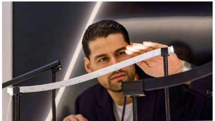
Biegsam. Flexible LED-Lichtbänder ermöglichen eine integrierte, nahezu unsichtbare Architekturbeleuchtung.
