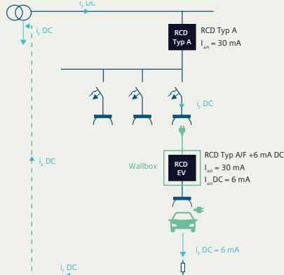
Wenn an einer vorhandenen Steckdose eine Ladeeinrichtung betrieben wird, die durch einen RCD des Typs A geschützt wird, ist es erforderlich, im Fehlerfall die glatten Gleichfehlerströme auf max. 6 mA zu begrenzen, um ein Erblinden des vorgeschalteten RCD zu verhindern.
