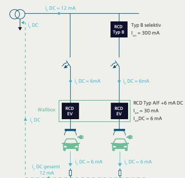
Bei mehr als einer Ladeeinrichtung muss ein RCD des Typs B vorgeschaltet werden, weil die DC-Fehlerströme sich im Fehlerfall aufsummieren können. Ein vorgeschalteter RCD des Typs A kann seine Schutzfunktion nicht mehr erfüllen.
