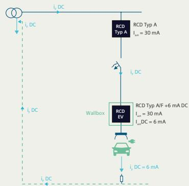
Um die Abschaltzeiten im TT-Netz einzuhalten, ist es auch bei festangeschlossenen Ladeeinrichtungen erforderlich, einen RCD vorzuschalten. Das Erblinden des RCD wird durch den RCD EV verhindert.
