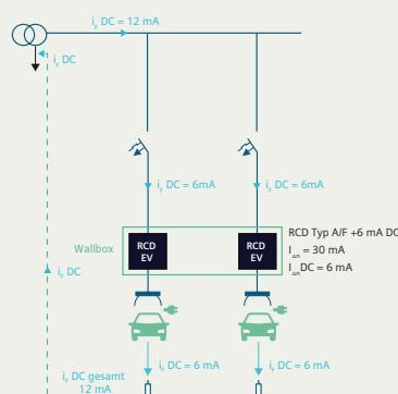
Bei fest angeschlossenen Ladeeinrichtungen kann ein vorgeschalteter RCD entfallen.
