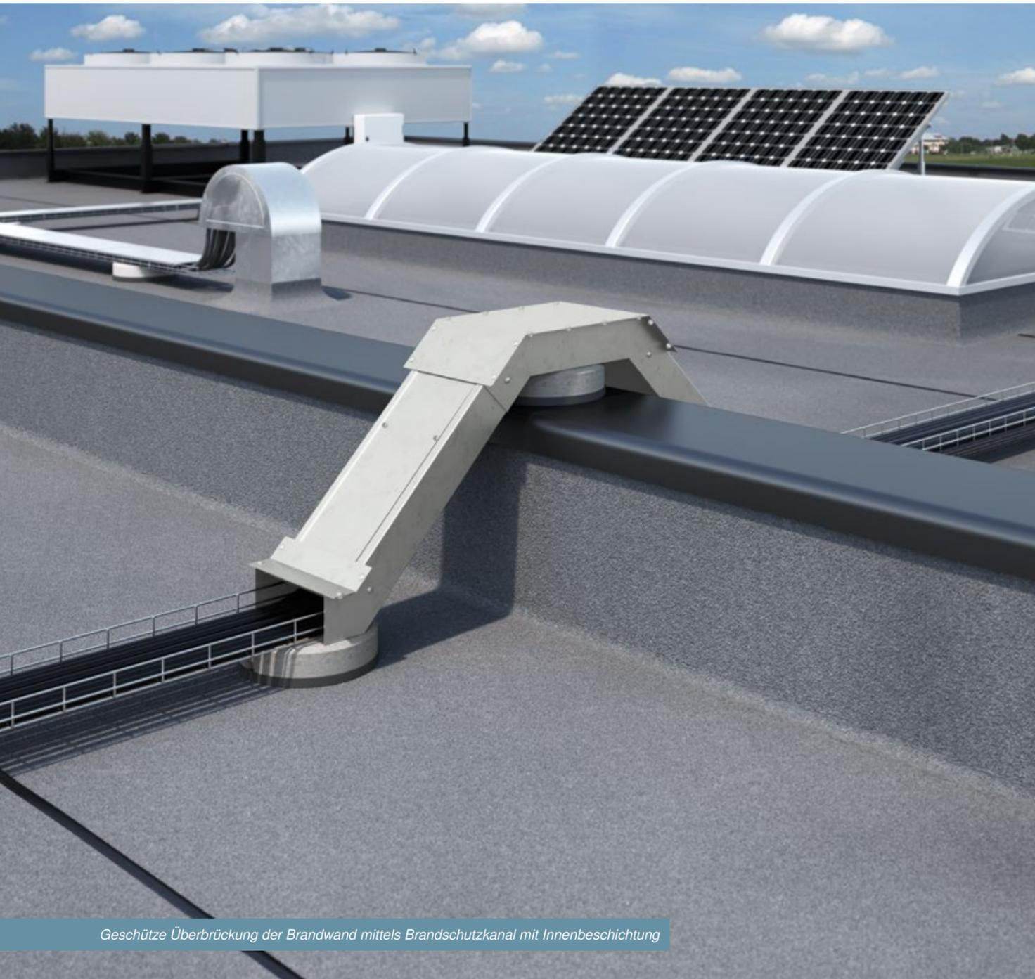
Geschützte Überbrückung der Brandwand mittels Brandschutzkanal mit Innenbeschichtung
