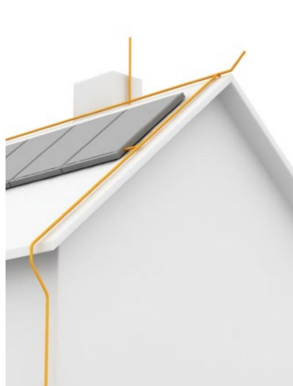
Direkter Anschluss der PV-Montagegestelle an das Blitzschutzsystem
