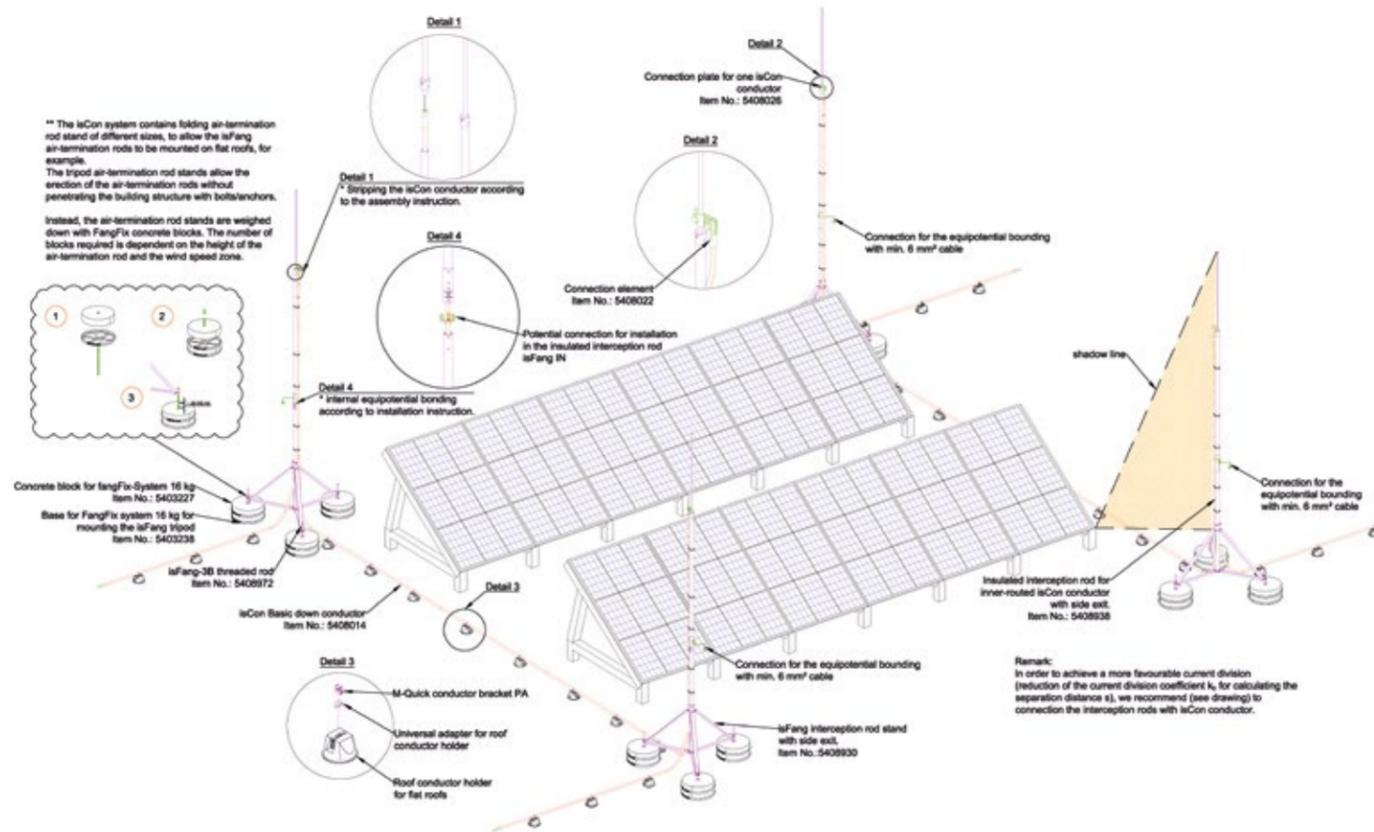
Beispiel einer geplanten, isolierten Blitzschutzanlage mit isCon®
