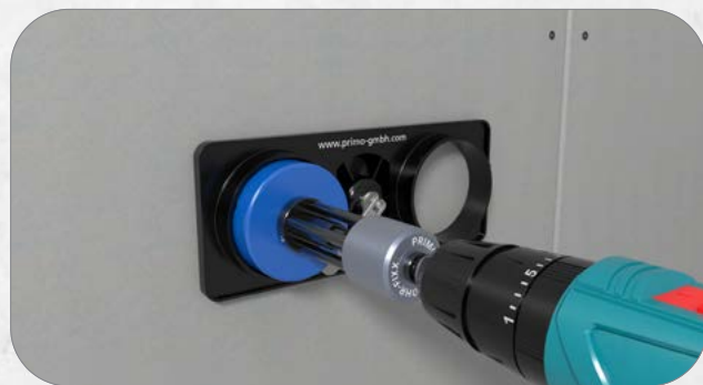
3. Für Mehrfachkombinationen Bohrschablone (PI02-74) ins erste Loch einsetzen. Mithilfe der integrierten Wasserwaage ausrichten und den Hebel festspannen. Durch Versetzen der Schablone beliebig viele weitere Löcher im genormten Abstand von 71 mm bohren.
