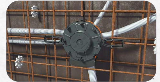
2. Membrane mit einem Cuttermesser öffnen. Werkzeuglose Kombieführung von Kabeln und (starken) Rohren von M9 – M40. Die Membrantechnik gewährt eine absolut betondichte Einführung.
