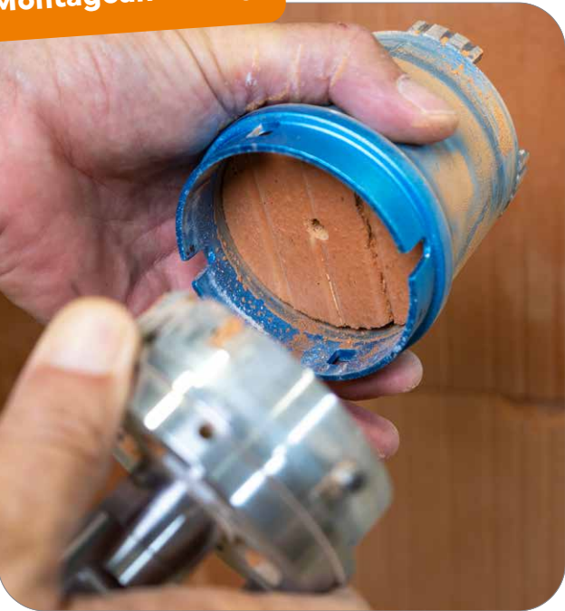
Diamantbohrkronen nach der Bohrung vom Bohr-Fixx Unterputz entriegeln und abnehmen.
