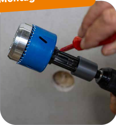
Aufbohrhilfe in den Bohr-Fixx (P779) einstecken und die Madenschraube festziehen.
