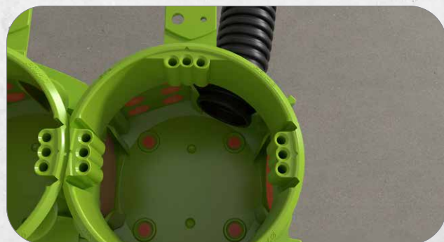
5. Kabel und Rohre durch den Cable-Plopp durchstecken und so komplett werkzeuglos einführen. Sichere Zugentlastung der Wellrohre durch Rohrgrip.
