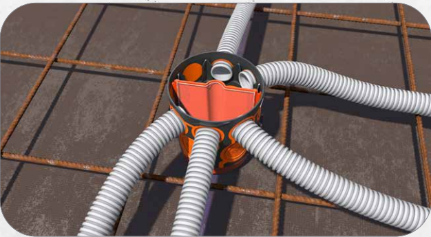
3. Kabel oder (starre) Rohre bis M40 werkzeuglos einführen. Sichere Zugentlastung durch Rohrgrip. Optionaler Trennsteg (P421-T) für zwei getrennte Stromkreise in einer Dose.
