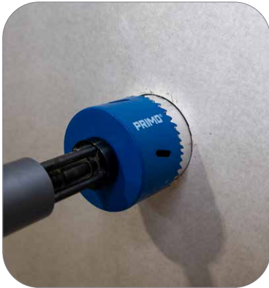
Die Aufbohrhilfe in bestehende 68 mm Bohrlöcher einstecken und auf 74 mm erweitern. Die Aufbohrhilfe dient als Zentrierhilfe für ein präzises Bohrergebnis.
