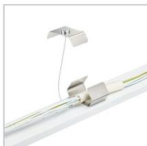
Die Sicherheitsclips mit Fangseil ermöglichen eine einfache Montage. Erst einhaken, elektrisch verbinden, dann den Lichtträger in die Schiene setzen
