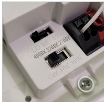
Mit zwei Minischaltern wird die Lichtfarbe und der Leuchtenlichtstrom anwendungsbezogen vor Ort einfach eingestellt.
