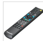
Erforderlich für ACL-Versionen: IRT9090/01 Fernbedienung Bestell-Nr.: 747 635 00 Mit Hilfe der Infrarotprogrammierung kalibriert und speichert dieses Tool das gewünschte Beleuchtungsniveau für Ihren Schreibtisch.
